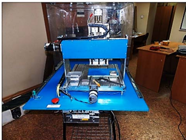
Рис. 4. Станок в сборе с защитным кожухом и аварийными выключателями
