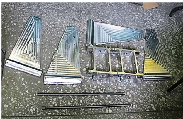
Рис. 2. Боковые стенки и направляющие для фрезерного портала
