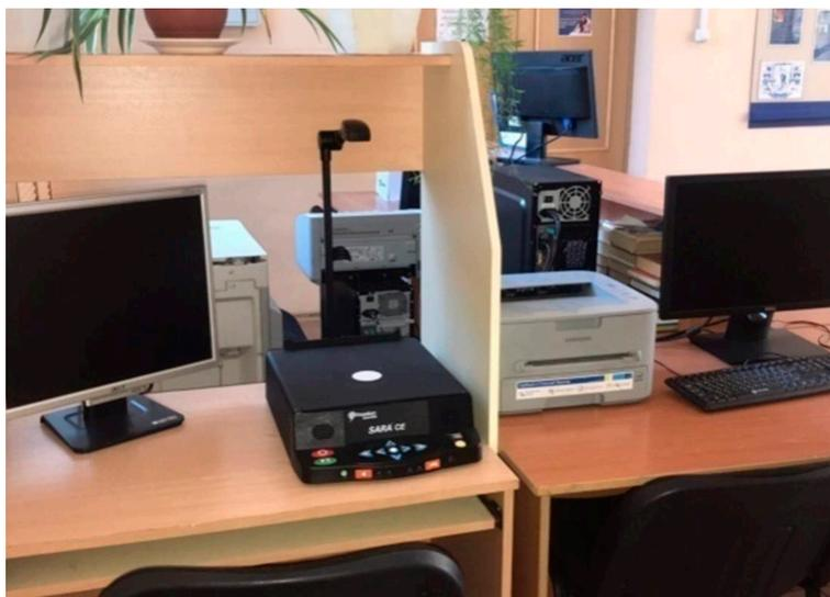
Рис. 62. Сканирующая и читающая машина *Sara CE* с камерой
