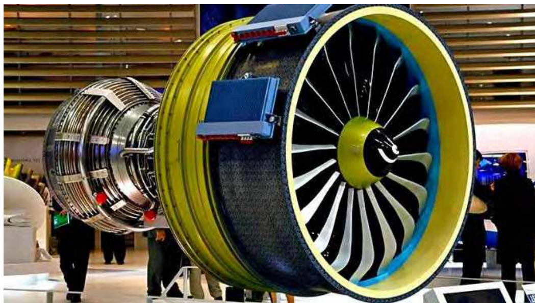
Рис. 2. Двигатель ПД-14 без внешней обшивки
